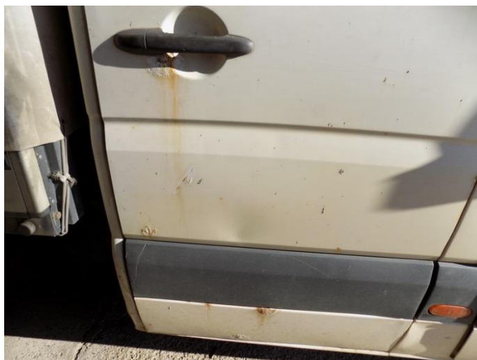
3. Volkswagen Crafter 2,5 TDI - oštećenje karoserije
