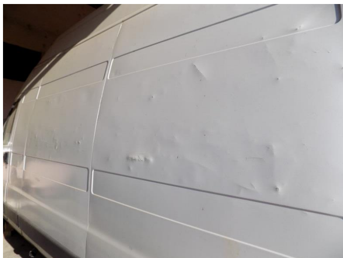
3. Citroen Jumper 2,8 - oštećenje karoserije
